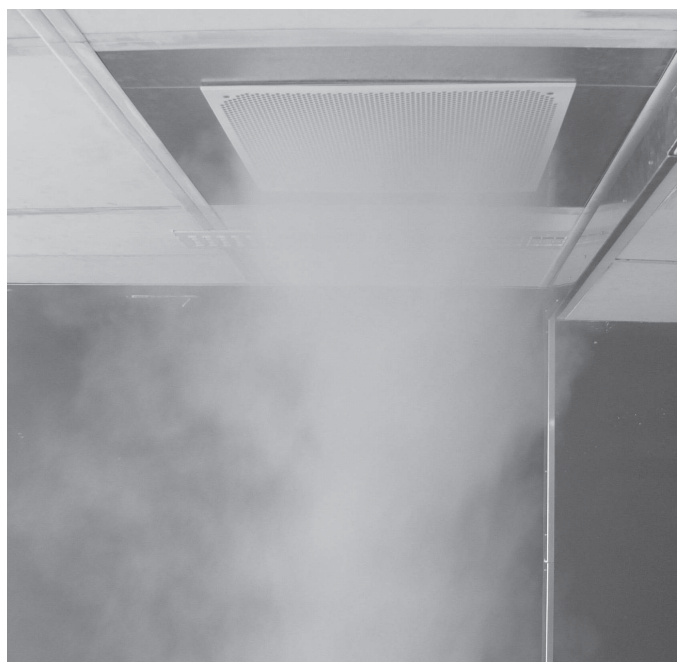
Rys. 5 Wizualizacja wypływu strumienia przez panel DCN-P (56% powierzchni czynnej)
