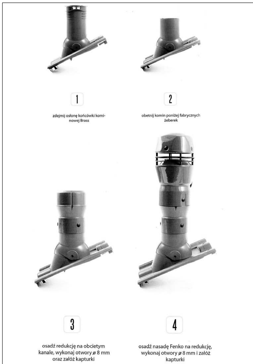
Rys. 7.11.3/2. Widok ogólny nasady hybrydowej „Fenko” i montaż na pokryciu dachowym typu „Brass”
