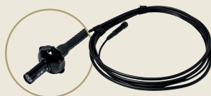
Sonda endoskopowa kombi HD (3 kamery) Ø 25 mm / 5 m / 0° / 2 x 90° z prowadnicą rolkową Nr artykułu. 11419
