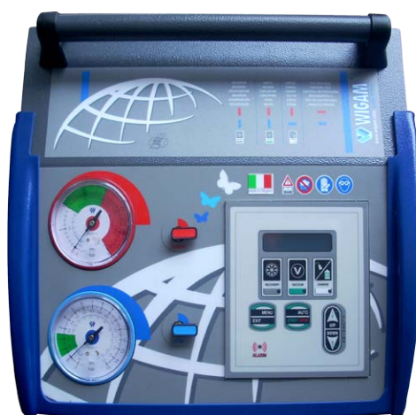
Panel sterujący stacji Piccola Data
