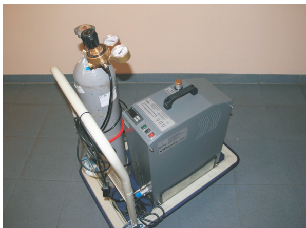
Foto. 13.1. Wytwornica dymu Smoke Concept ViCount 2.2 kW na wózku platformowym
