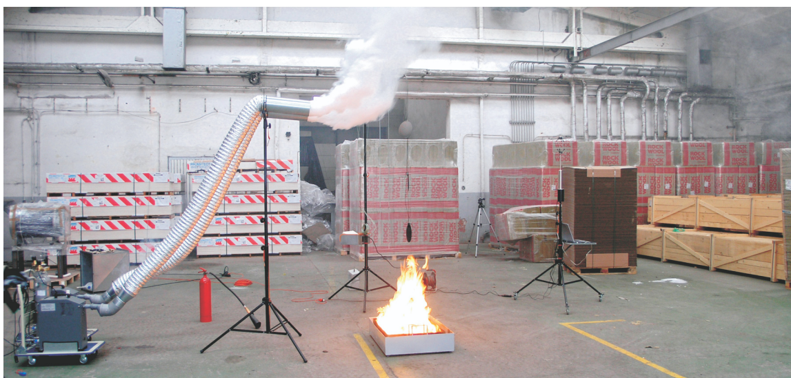
Foto. 13.2. Kompletne stanowisko pomiarowe do prowadzenia prób z zastosowaniem gorącego dymu
