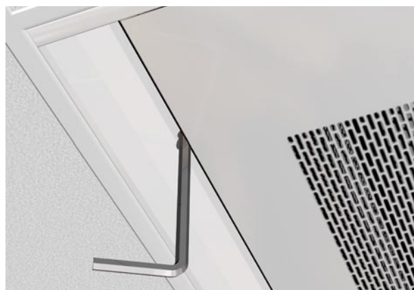
Dokręcanie śrub regulacyjnych przy pomocy sześciokątnego klucza imbusowego, bez potrzeby zdejmowania płyty dolnej.
