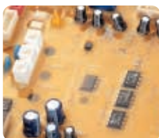
PCB pokryta powłoką poliuretanową
