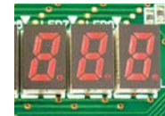
Wyświetlacz 7-segmentowy na płycie drukowanej jednostki zewnętrznej
