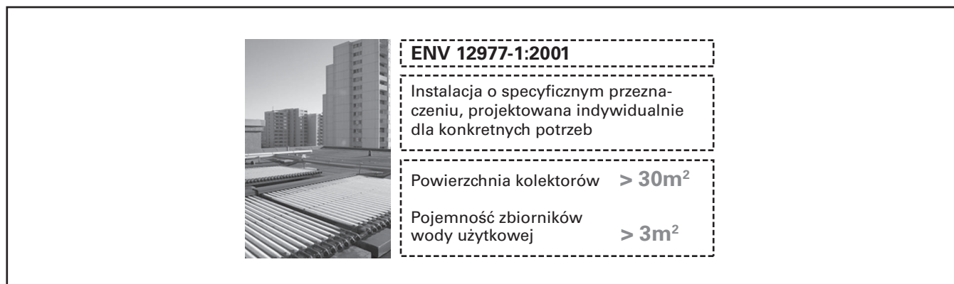
Rys. 4.3. Definicja normowa dużej instalacji z kolektorami słonecznymi.
