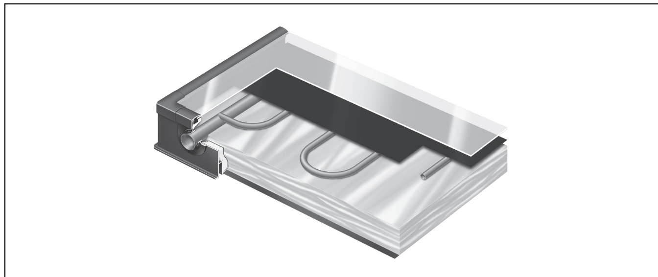
Rys.2.2. Szczegóły budowy płaskiego kolektora słonecznego Vitosol 100 2,3 m 2
