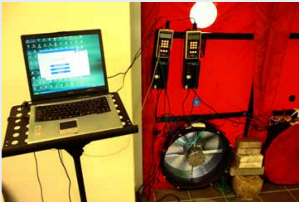
Pomiar szczelności budynku, hala sportowa w Słomnikach
