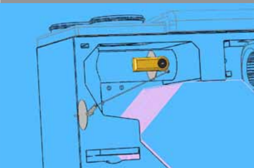
Przepustnica zamknięta na by-passie, otwarta na wymienniku – powietrze przepływa przez wymiennik
