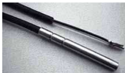
Fot. 4. Czujnik temperatury
