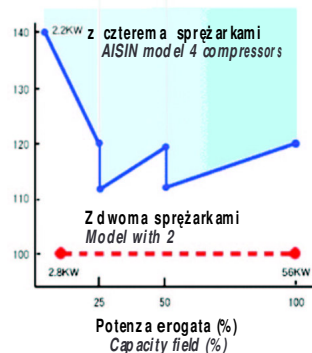
Diagram porównania efektywności : modele z dwoma czterema sprężarkami Efficiency comparison diagram: 2 compressors model and new compressor model
