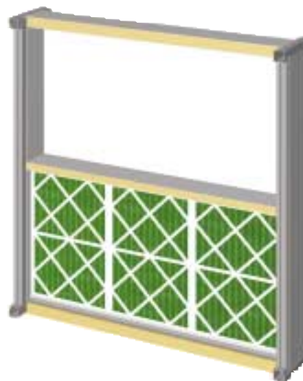
Umieszczenie filtru u dołu centrali o podwójnej wysokości
