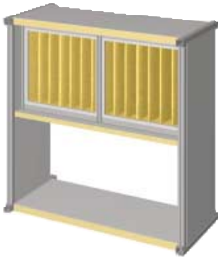
Umieszczenie filtru u góry centrali o podwójnej wysokości
