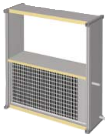
Umieszczenie nagrzewnicy wodnej w centrali o podwójnej wysokości
