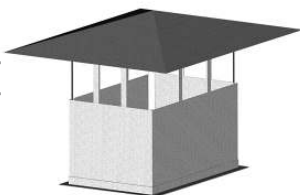
Wyrzutnia dachowa typ A wg BN-70/8865-31
