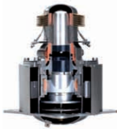
Silnik Sterling w module Vitotwin 300-W firmy Viessmann pracuje bez wału korbowego w hermetycznie zamkniętym systemie, dzięki czemu nie wymaga konserwacji.
