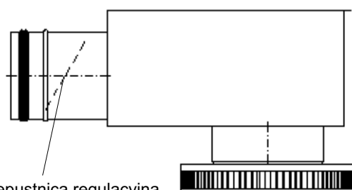
Rys. 28. Przykład nawiewnika ze skrzynką rozprężną, wyposażoną w przepustnicę regulacyjną.
